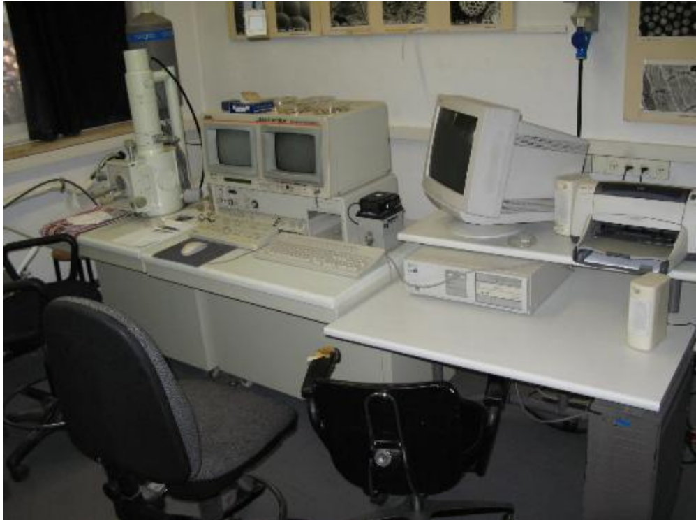
Hình 2.6. Kính hiển vi điện tử quét JSM – 5410LV (JEOL- Nhật Bản)
