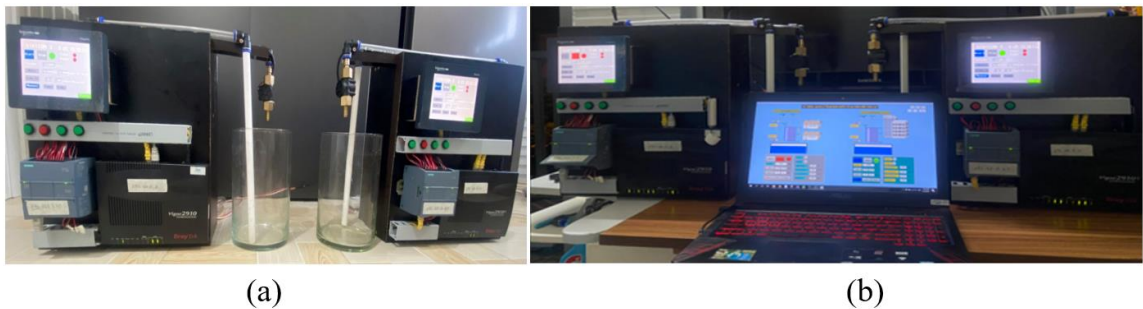
Hình 11. (a) mô hình 2 node trạm bơm (b) máy tính điều khiển từ xa qua VPN access
