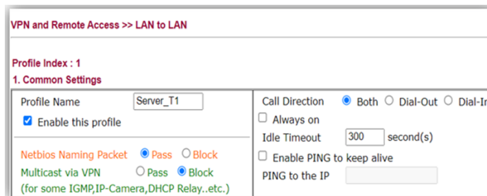
Hình 3. Cấu hình VPN site to site cho modem
