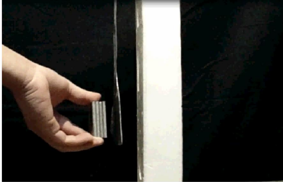
Hình 10. Video TN kiểm tra sự xuất hiện dòng điện Fu-cô 4.5. Học liệu phục vụ vận dụng kiến thức
