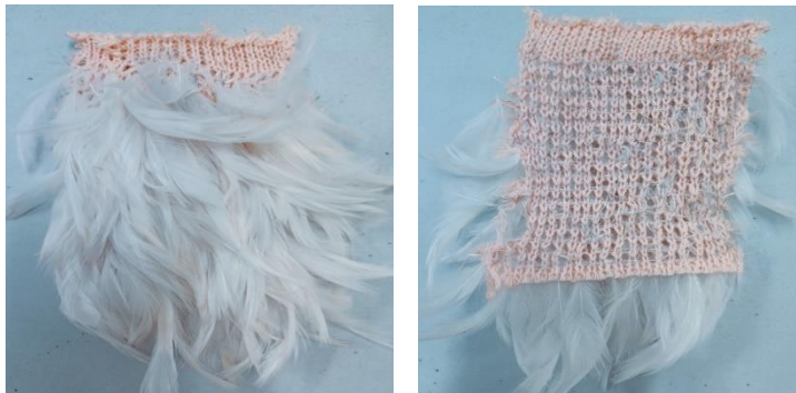
Hình 6. Mặt phải và mặt trái mẫu vải cài lông vịt (Dệt thực nghiệm trên máy 5G, với lông ổng chiều dài 9 cm)
