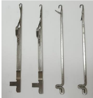
Hình 5. Cấu trúc kim chuyển vòng (phía trái) và kim thông thường (bên phải).
