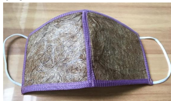
Hình 9. Hình ảnh về khẩu trang hoàn chỉnh từ sợi chuối kháng bức xạ UV
