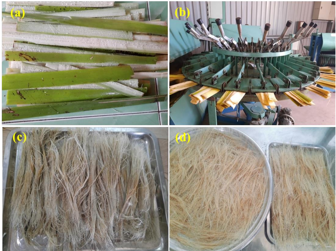
Hình 3. Các nguyên liệu từ bẹ chuối: bẹ chuối đã được cắt thành những đoạn nhỏ (a), bẹ chuối trên máy chải sợi (b), bẹ chuối sau khi được chải (c) và sợi chuối được phơi khô ở nhiệt độ phòng (d)
