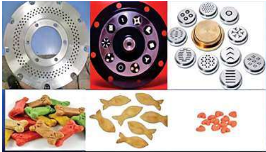
Hình 4. Một số kiểu đĩa khuôn và hình dạng sản phẩm từ máy ép đùn (Kearns, 2012)
