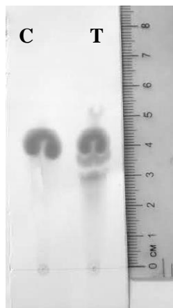
Hình 1. Sắc ký đồ curcumin của mẫu chuẩn và mẫu thử (C: mẫu chuẩn; T: mẫu thử)
