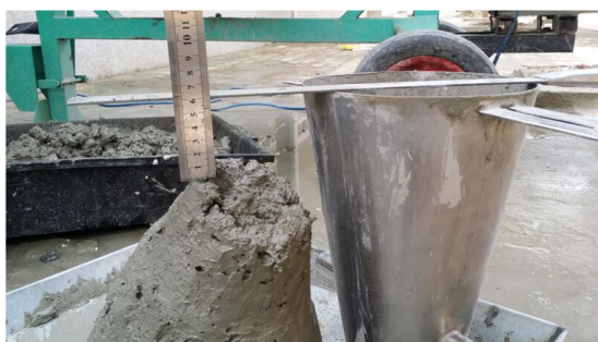
Hình 2. Xác định độ sụt của hỗn hợp bê tông
