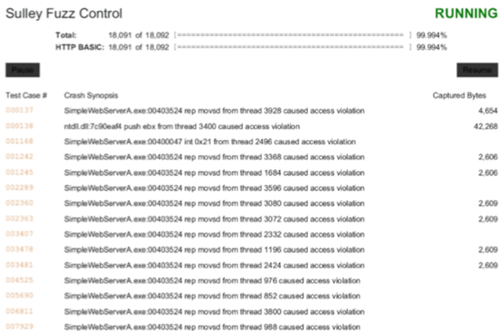
Hình 5. Màn hình bug lỗi khi gửi các yêu cầu đến trang Web tạo bởi Sulley
