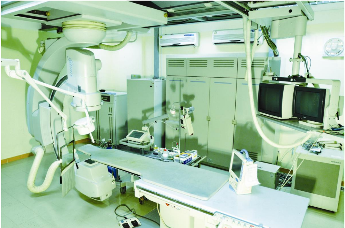
Hình 2.2: Hệ thống máy chụp mạch của hãng Toshiba
