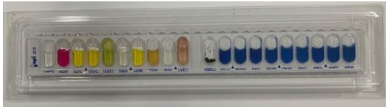
Hình 9. Kết quả định danh chủng vi khuẩn A6LL là vi khuẩn Pseudomonas putida
