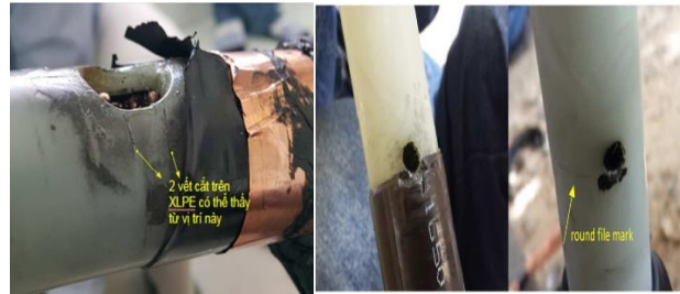
Hình 12. Cắt phạm vào lớp cách điện và bán dẫn khi thi công chuẩn bị đầu cáp [20]
