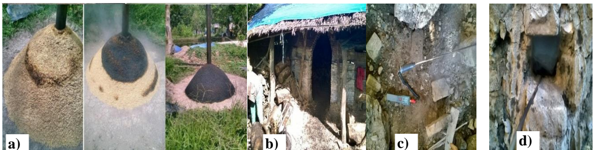
Hình 1: a) Lò hầm than trấu; b) Lò hầm than tre; c) Máy đo nhiệt độ lò hầm than; d) Điểm đặt điện cực đo nhiệt độ lò hầm
