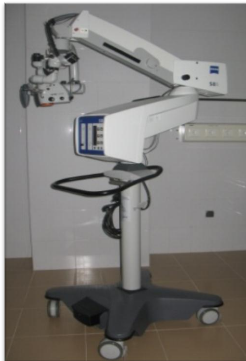
Hình 2.17. Kính vi phẫu thuật Zeiss OPMI Vario S88, Germany
