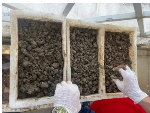
Hình 6. Đảo trộn trong quá trình ủ tùy nghi và sản phẩm ủ tại phòng thí nghiệm.
