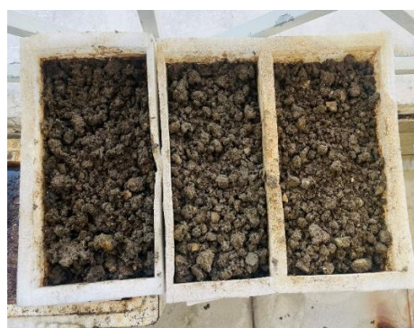
Hình 6. Đảo trộn trong quá trình ủ tùy nghi và sản phẩm ủ tại phòng thí nghiệm.
