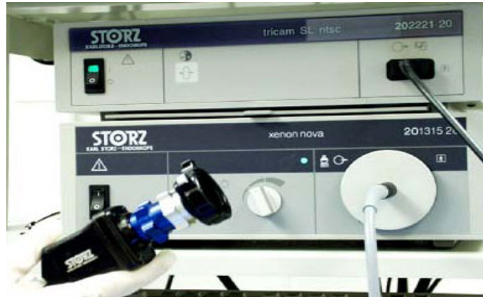
Hình 2.1. Bộ ghi hình loại 3 chip với nguồn sáng xenon sử dụng trong mổ
