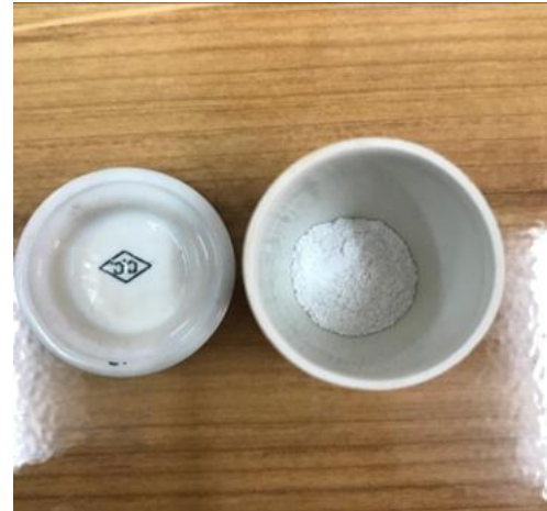
Hình 3. Sản phẩm TiO_2NPs điều chế bằng phương pháp thủy nhiệt
