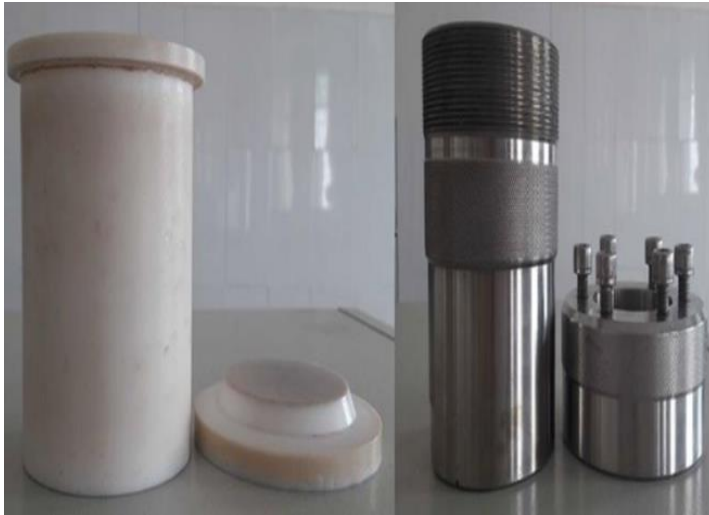
Hình 2. Bình thủy nhiệt dùng để chế tạo mẫu
