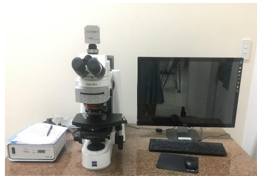
Hình 2.8: Kính hiển vi huỳnh quang (Công ty Zeiss, Đức)
